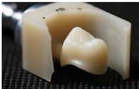
設計に基づき削り出し (CAM)
