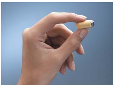
●図1 飲み薬のような大きさのカプセル内視鏡
